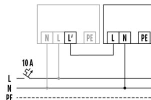
Raccordement standard avec interrupteur
