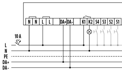
Raccordement avec commande optionnelle par poussoirs.
